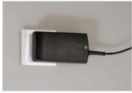
Elektronisches Schaltnetzteil (Switch Mode), direkt hinter Netzstecker integriert (24 Volt-Antriebssystem serienmäßig)
